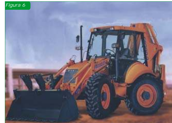
Fig.6: terna gommata con 4 ruote motrici sterzanti e benna autoscaricante
