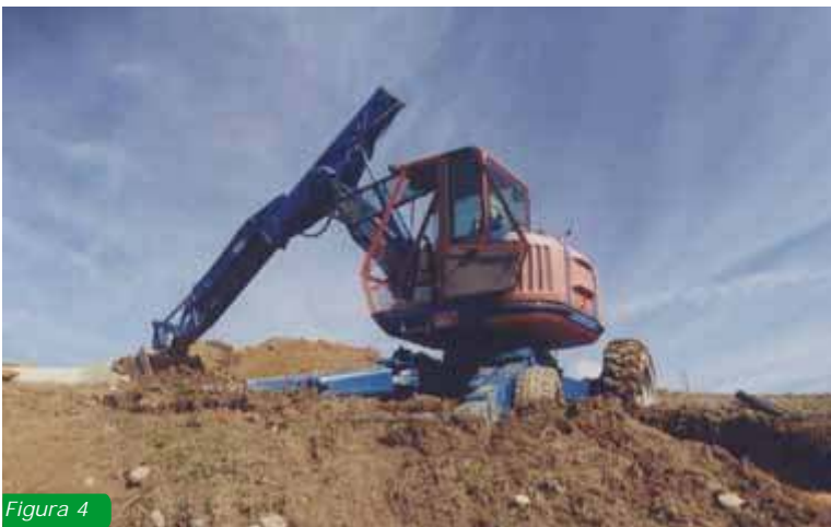
Fig.4: ragno meccanico dotato di avambraccio telescopico. I bracci di traslazione sono anche dotati di ruote per più rapidi spostamenti al di fuori del punto di lavorazione
