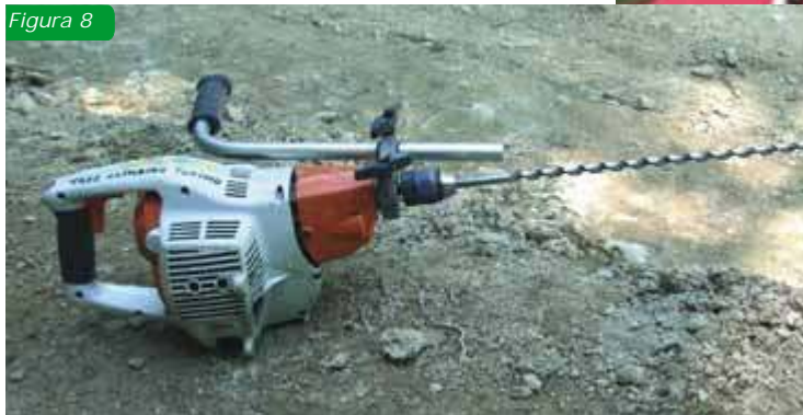
Fig. 8: trapano a rotazione, funzionante con motore a scoppio
