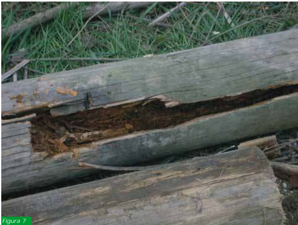
Figg. 7-8: degradazione del legname per attacco biotico
