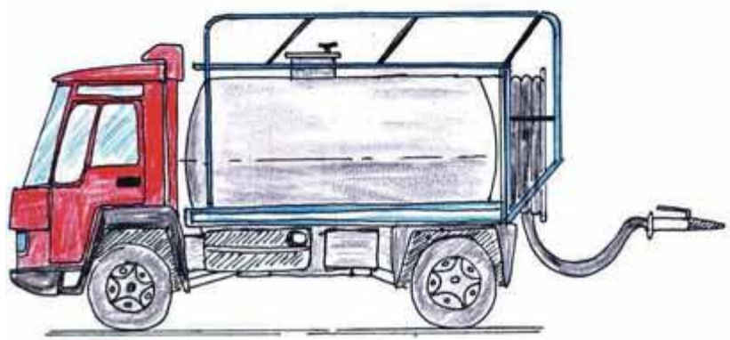
IDROSEMINATRICE FISSA SU AUTOCARRO 70 Q.LI CAPACITA' 5000 LITRI
