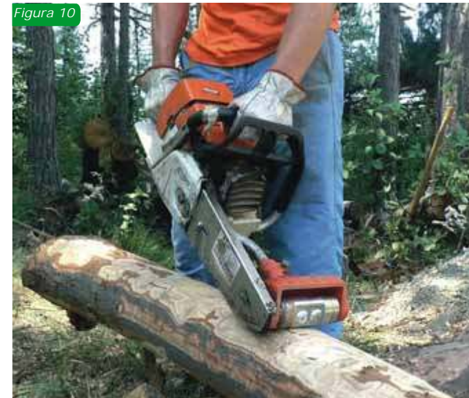
Fig. 10: motosega adattata a scortecciatrice meccanica
