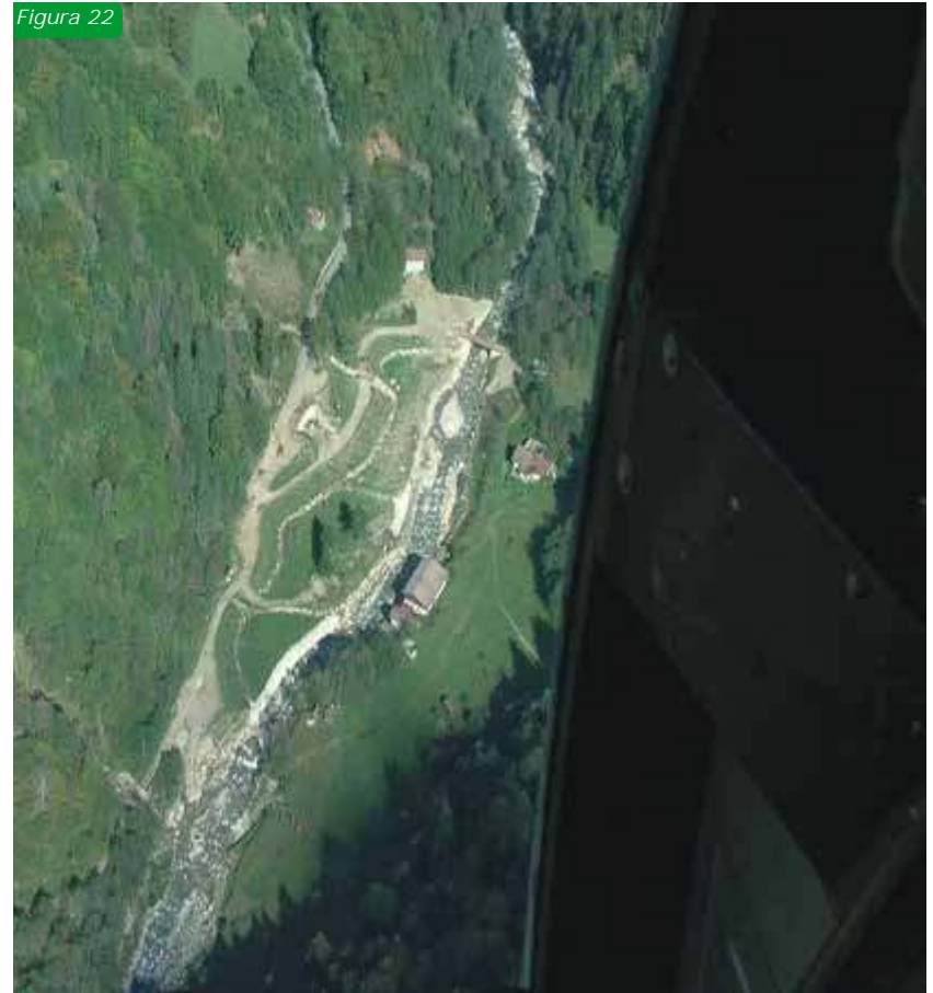
Figg.21-22: vasta operazione di movimentazione di terra, massi d'alveo e massi di cava, per la realizzazione di un'area nella quale il torrente può espandersi, dissipando la sua energia. Grande cura è stata dedicata alla sistemazione delle superfici ed agli inerbimenti.
