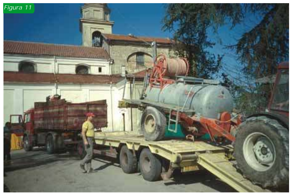
Fig.11: idroseminatrice a rimorchio: viene attivata dalla presa di forza del trattore agricolo
