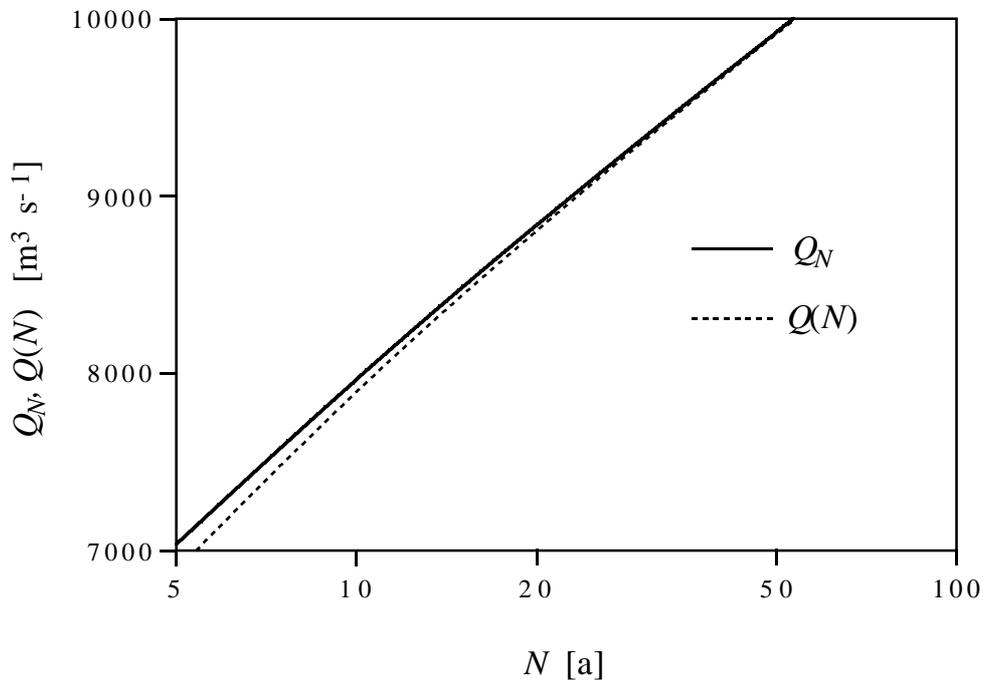
Po a Pontelagoscuro. Confronto tra il massimo della portata al colmo  $Q_N$  in un periodo di  $N$  anni (con probabilità di non superamento uguale a 0,368) e il massimo della portata al colmo  $Q(N)$  con tempo di ritorno di  $N$  anni.
